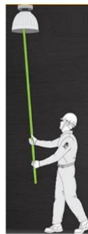
1. Eliminación del peligro: la solución preferida es eliminar la exposición al peligro de caída
