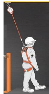
4. Detención de caídas: usar equipos de protección personal para detener una caída dentro de los márgenes claros y aceptables de fuerza y energía requeridos. *Planificación de entrenamiento y rescate requerida
