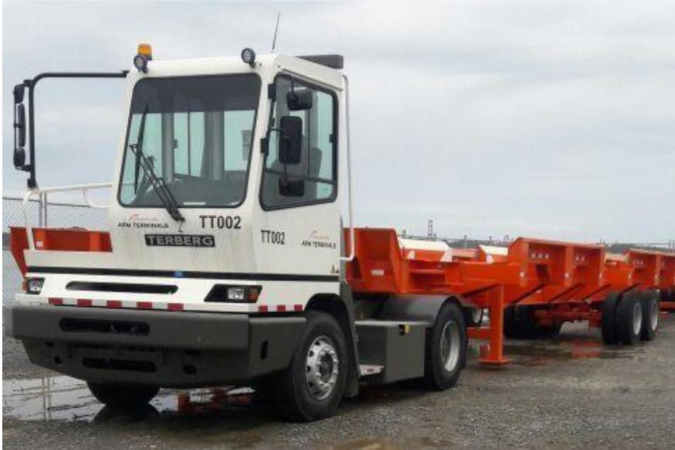
*Figura 10. Conjunto camión de terminal y chasis.*
