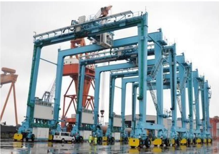
*Figura 7. Grúas eRTG estacionadas. Centro de manufactura de grúas ZPMC, China.*
