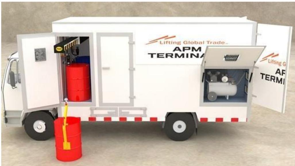
Figura 16. Diseño del camión de mantenimiento de la TCM.
