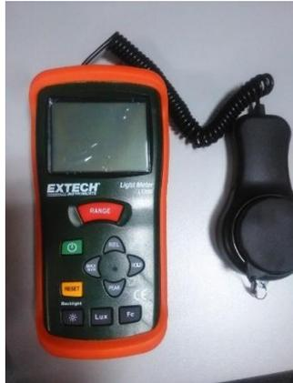
**Figura 6.** Luxómetro utilizado en la medición.
