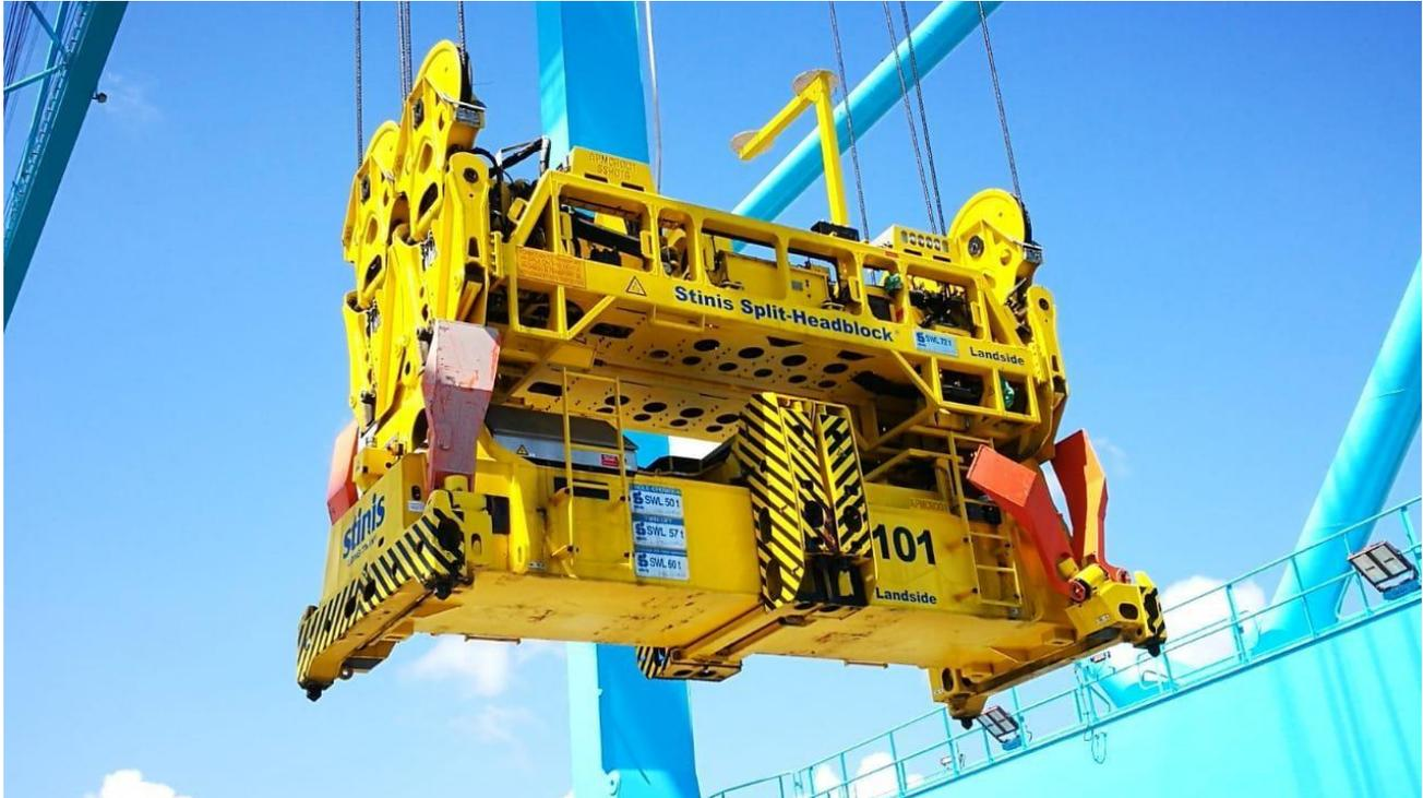
Figura 8. Spreader tipo Twin para grúa STS: Fabricante Stinis.
